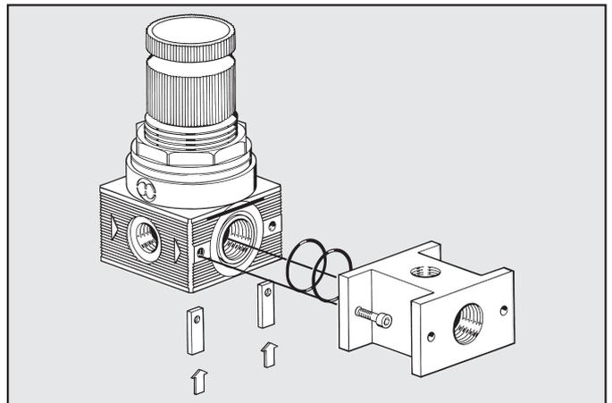
Montaje de toma de aire a la salida: utilizar únicamente nº 2 tornillos y juntas OR suministradas en el kit PA; la estanqueidad está asegurada por el contacto OR-OR.
