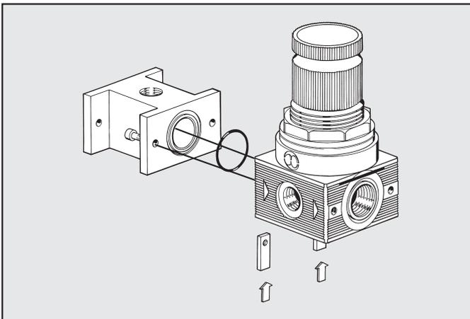
Montaje de toma de aire en la entrada: utilizar únicamente nº 2 tornillos y juntas OR suministradas en el kit PA.
